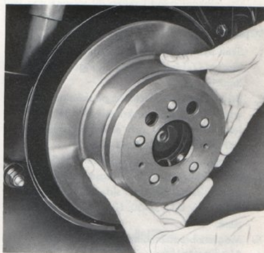
Bild 5—17. Demontering av bromstrumma
