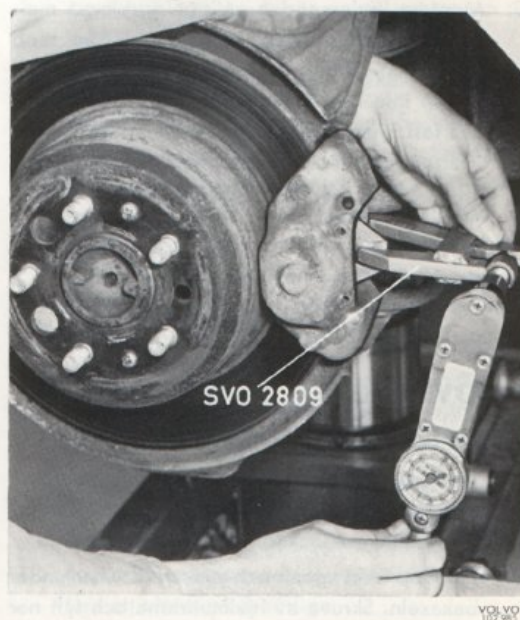
Bild 5—5. Inpressning av kolv
