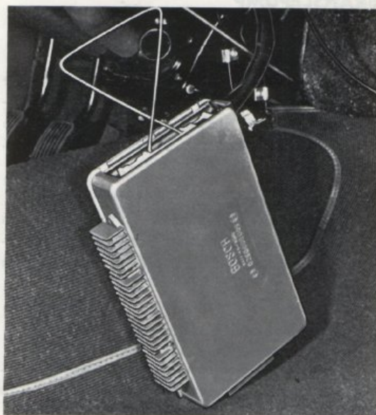
Bild 2—36. Demontering av stickkontakt
