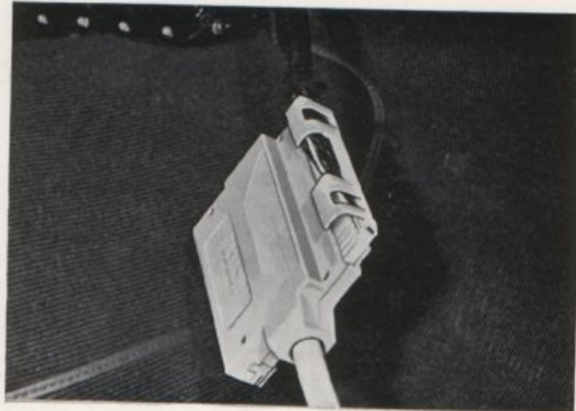
Bild 2—31. Testinstrument anslutet till ledningsmatta
