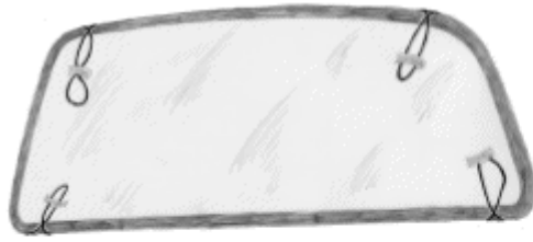
Die Scheibe wird mit Dichtung und Wäscheleine auf den Rahmen gelegt.
