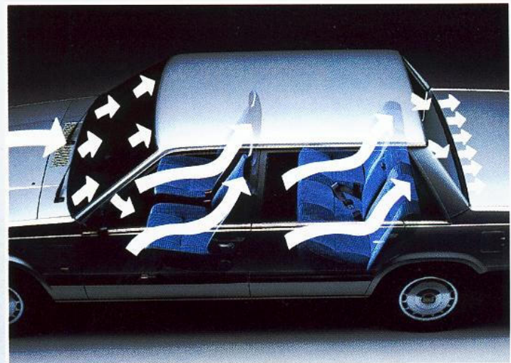
Nicht weniger als 13 Luftdüsen sorgen für eine rasche und wirksame Heizung und Belüftung des ganzen Wagens. Die Einstellung ist ebenso einfach wie präzise.
