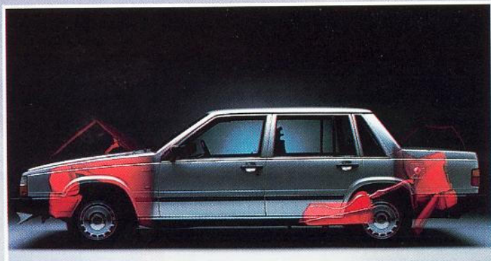
Knautschzonen vorn und hinten schützen die Insassen. Der Kraftstofftank ist an gut geschützter Stelle vor der Hinterachse angebracht.
