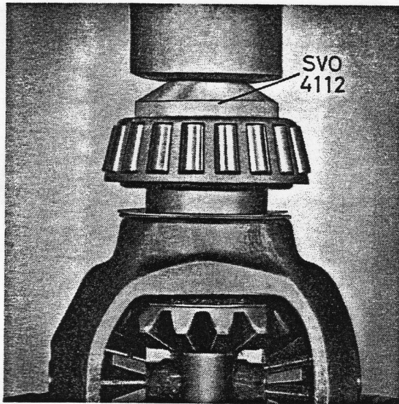
Bild 5-30. Einbau des Ausgleichgetriebegehäuselagers
