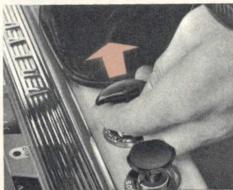
2. Wenn der Motor kalt ist, ziehen Sie den Knopf für die Kaltstartvorrichtung heraus. Ist der Motor warm, geben Sie etwas Gas und lassen den Knopf in seiner Normalstellung.
