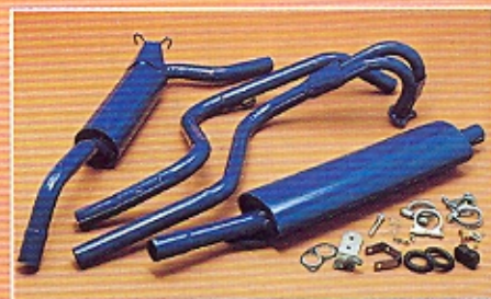
1156630-6 Rally Avgassystem Komplett för B 14-motor, fr.o.m. 1980 års modell. 1156710-4 Rally Avgassystem Komplett för B 14-motor, fr.o.m. 1981 års modell.
