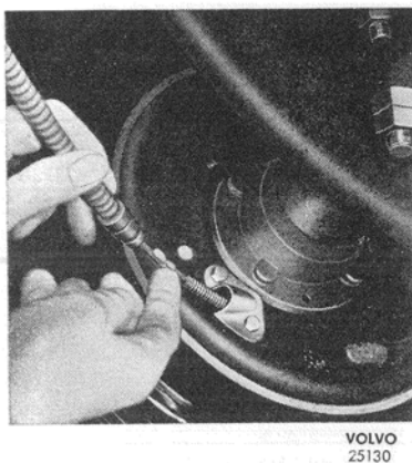
Fig. 27. Lubricating the handbrake cable
