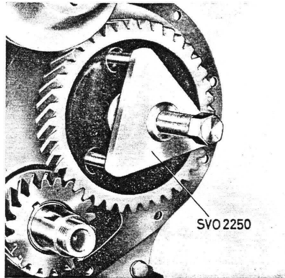
Bild 1-36. Ausbau der Ventilsteuerung
