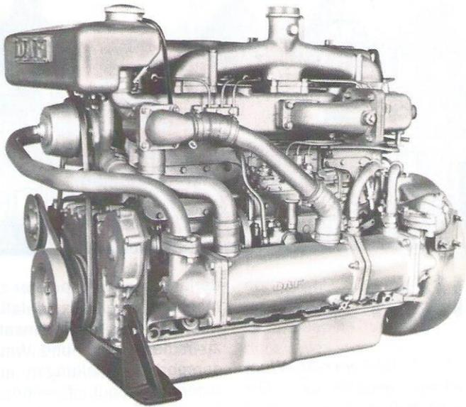
Der legendäre DAF 575 mit 77 kW (105 PS) für die Schifffahrt.
