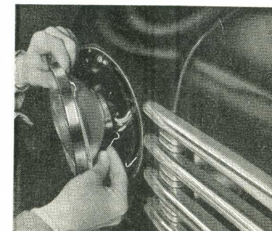
4. Drag ut insatsen och lossa den lilla fjädern, som håller glödlampsinsatsen.
