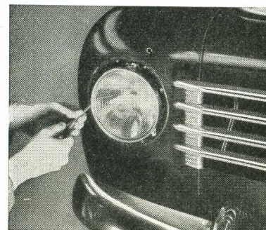
3. Lossa de tre skruvarna, som håller fast insatsen.
