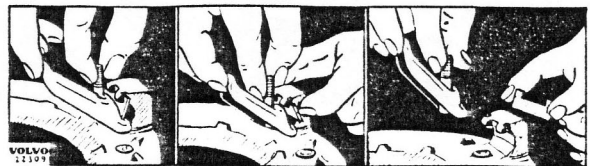
Bild 2-11. Ausbauen der Kupplungshebel
