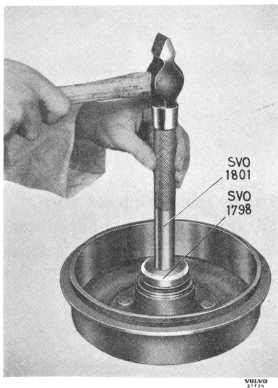
Bild 9. Montering av tättningsring.
